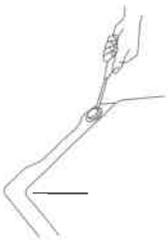
4 内部排水ホースの固定バンド部を手で取外す。フック部を洗濯機内部方向に押しながら固定バンド部を下から上方向に外す。
